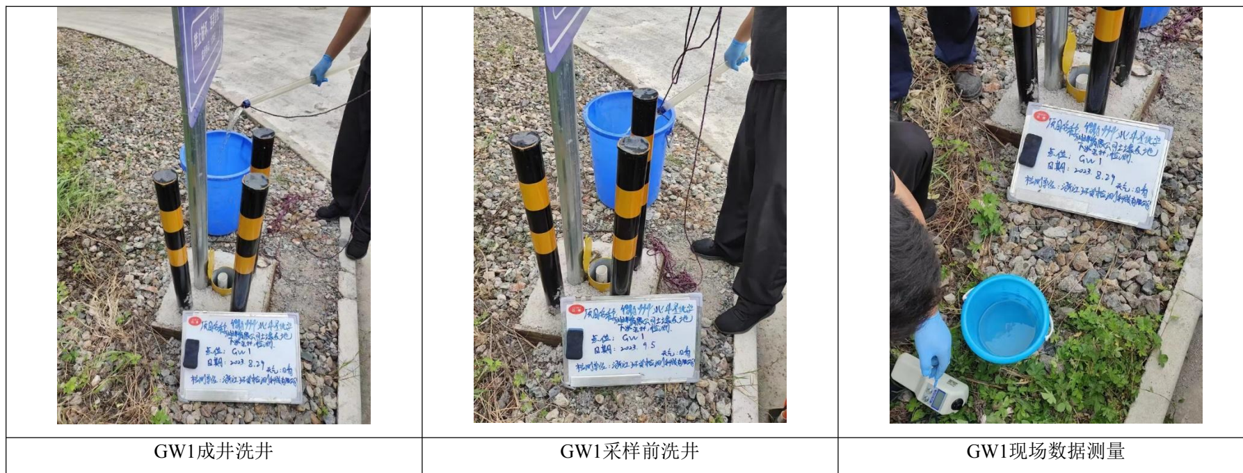
图10-2 地下水洗井采样照片
