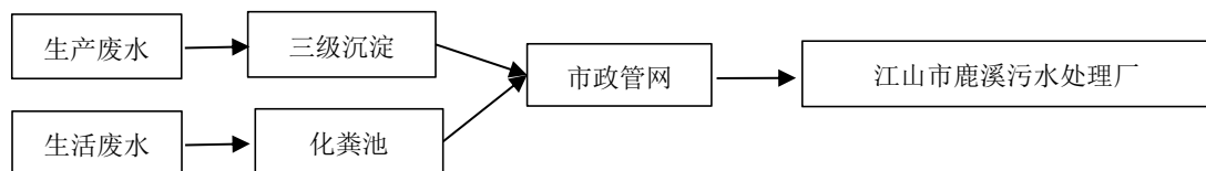
图3-1 项目废水处理工艺
