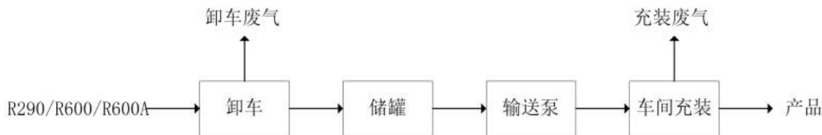
图2.6-9 单工质碳氢制冷剂工艺流程图
