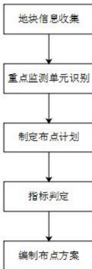
图 1.3-1 编制布点方案工作程序图
