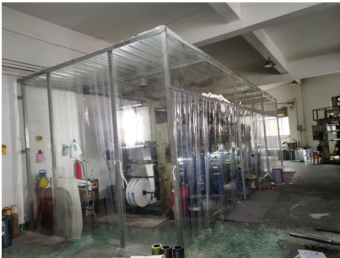
图3-2 印刷、调墨车间密闭收集图
