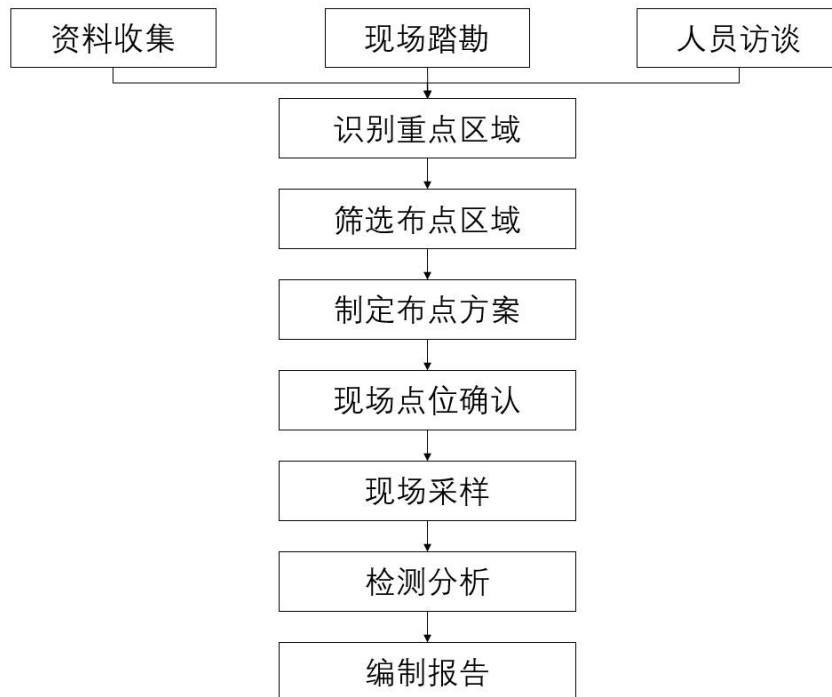
图 4.3.1-1 自行监测工作程序图
